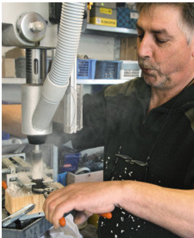
Der Meister in Aktion: Mit Hilfe eines Spezialwerkzeuges entfernt Klaus Demmel einen Teil der porösen Schwammschicht.
